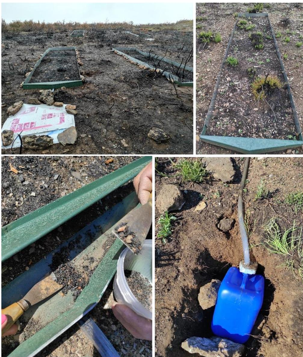
Figura 6. Parcelas de erosão e colheita de escoamento superficial e sedimentos nas frentes das parcelas instaladas após o fogo na Parcela da Aveleda. Fonte: Ana Royer (2021).
