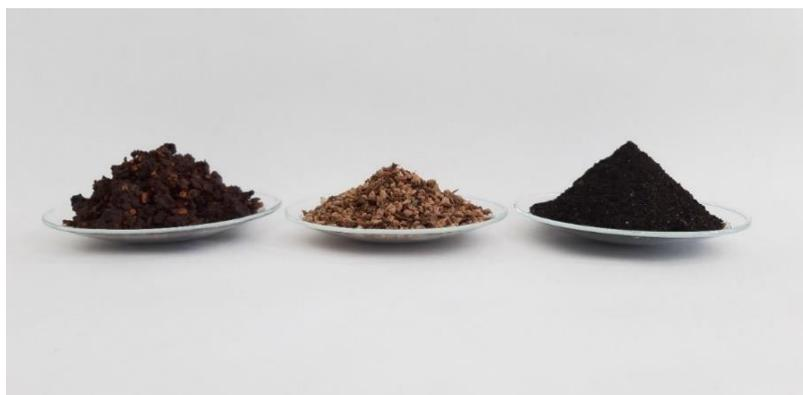
Figura 29. Subprodutos utilizados no processo de produção de biochar (da esquerda para a direita): bagaço de azeitona fresco, extratado e seco, e carvão ativado. Fonte: Costa, S. (2023).
