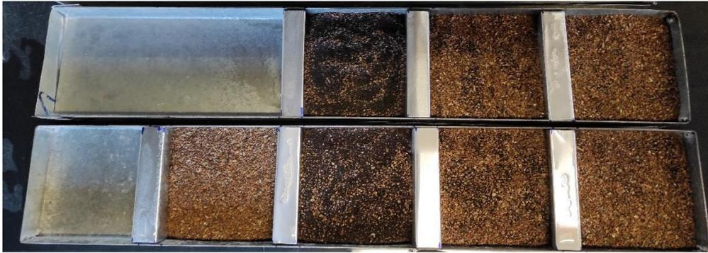
Figura 40. Ensaio a microescala de efeito dos compostos sob os agregados do solo.
