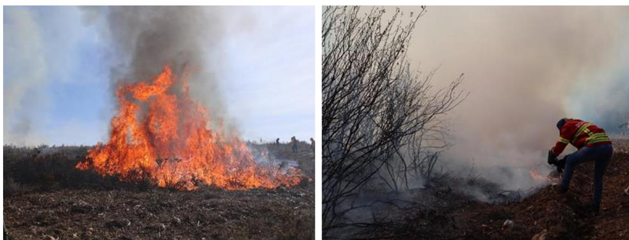
Figura 4. Fogo controlado e medição da temperatura do solo e da chama, com câmara termal.
