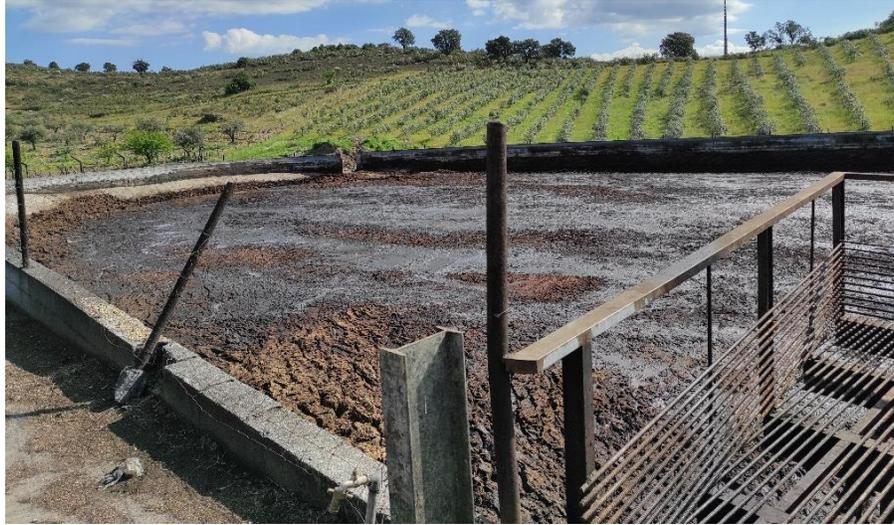
Figura 24. Balsa de armazenamento de bagaço de azeitona onde o subproduto é depositado até poder ser processado pela indústria extratora.
